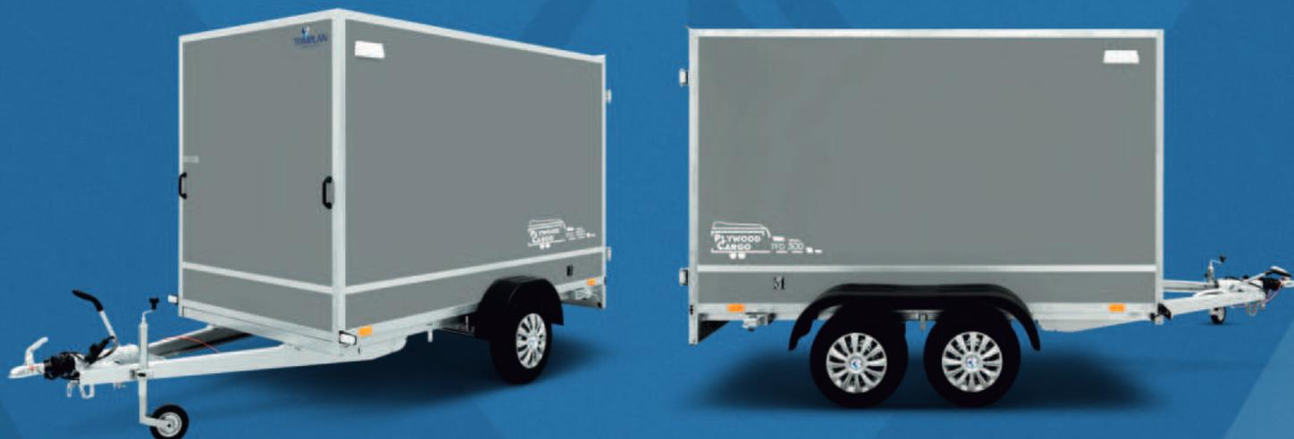
Chacun des fourgons est doté en série de points d'arrimage dans le plancher, de 2 supports arrière et d'une roue de support ce qui contribue à la stabilité lors du chargement, du transport et du déchargement. En outre, il est possible de mettre en place des lattes latérales ce qui rend plus facile le chargement et des barres de toit permettant d'installer un porte-bagages ou un coffre de toit ce qui contribue à une meilleure fonctionnalité et augmente la charge utile d'une remorque.
