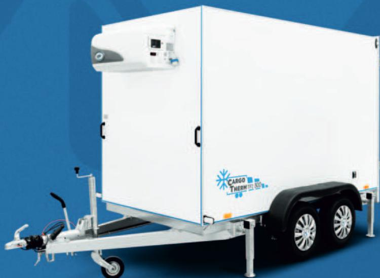
L'épaisseur des parois et du toit est d'environ de 54 mm, et une isolation en Styrodur, un revêtement extérieur et intérieur en stratifié lisse de la couleur blanche contribuent à une isolation thermique parfaite. Un plancher épais de 60 mm est recouvert de tôle d'aluminium damier ce qui contribue à une longue durée de vie et rend son nettoyage facile. Ce modèle peut être doté en outre d'une porte latérale, d'un support de la roue de secours ou d'amortisseurs de l'essieu.
