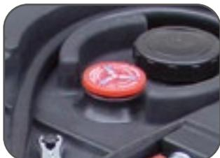
Soupape de surpression et d'aération
