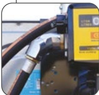
Raccord tournant en sortie de compteur
