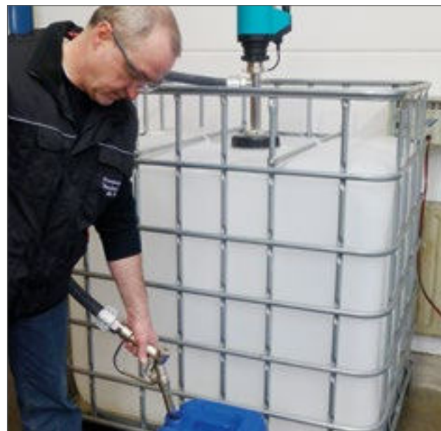
4 Pompe ATEX, pour solvants et liquides inflammables
