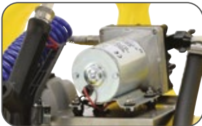
Pompe électrique à diaphragme 12 V
