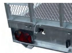
Assistance au basculement de la rampe arrière par 2 vérins puissants
