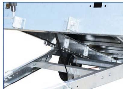
Basculant grâce à un vérin à gaz
