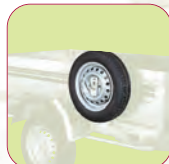
Porte roue de secours latéral (pouvant recevoir un cadenas)
