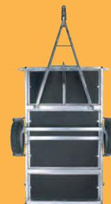
Châssis entièrement mécano-soudé avec traverses de renfort anti-vibration.
