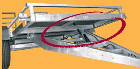
Vérin pour ralentir la descente du plateau basculant. Flèche en U soudée et pentée.
