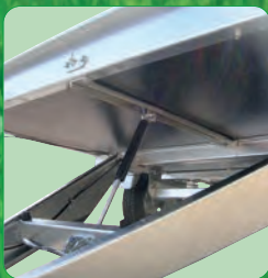
BASCULEMENT AVEC VÉRIN À GAZ LIVRÉ DE SÉRIE
