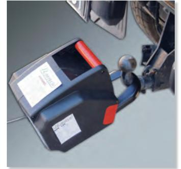
Treuil électrique 12 V avec poulie de mouflage et câble en fil d'acier torsadé. Cordon d'alimentation muni d'une prise résistant aux projections d'eau et d'un disjoncteur. Pour une plus grande sécurité, commande à distance avec prise étanche. Manivelle d'urgence à embrayage réglable. Livré avec un équipement pour installation sur une boule de remorquage.
